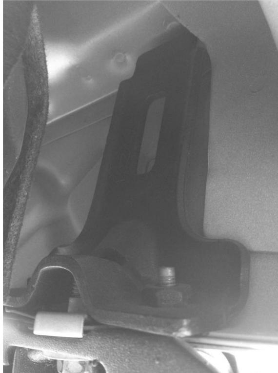
**Figure 3 - OEM CHEVY HD UPPER SUPPORT BRACKET**
